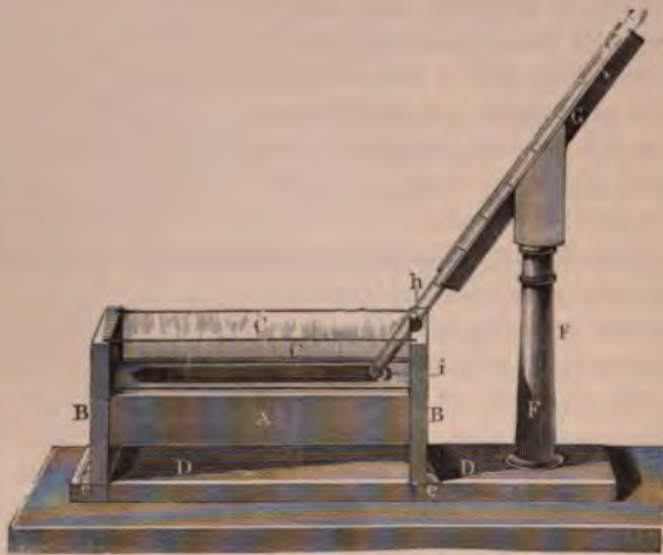
Fig. 90. — Cuve pneumatique et eudiomètre à mercure de Bunsen.
